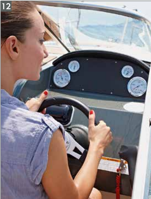
Puesto de mando integrado con dirección hidráulica, instrumentación SmartCraft, espacio para un GPS 7"/sonda de profundidad opcional y enchufe de 12v
