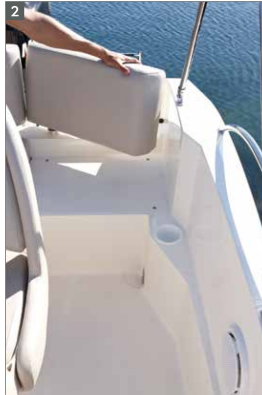
2 Acceso directo desde la plataforma de baño a la bañera gracias al respaldo giratorio del asiento
