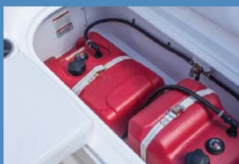
Depósito de gasolina de 22.7L con interruptor (Element 180 XL)
